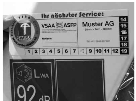
Bild 4: Die Fälligkeit der nächsten Instandhaltung kann zum Beispiel mit einer Prüfplakette am Gerät angegeben werden.
